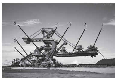
图1 悬臂式斗轮堆取料机组成
