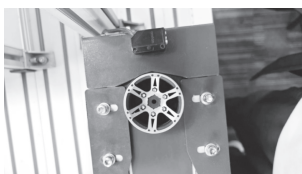
图17 视觉传感器对目标物体的识别
