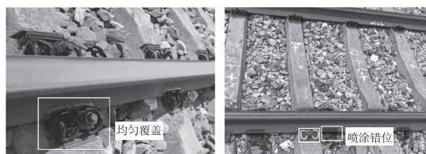
(a) 安装本文传感器涂油设备喷涂效果 (b) 其他相似设备喷涂效果
