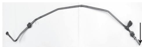
图 1 供油管外观及裂纹位置(箭头所指)
