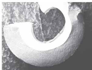
图5 断口宏观形貌(25×)
