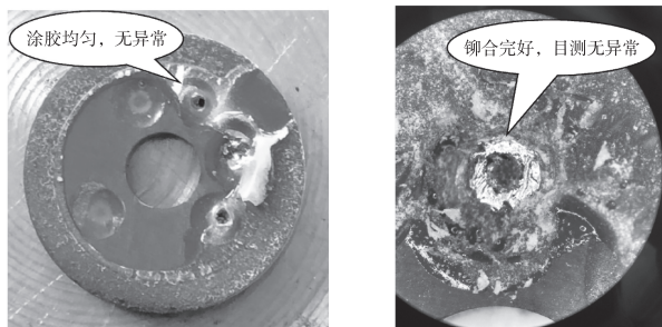
图6 电位器引出线涂胶放大图
