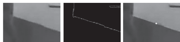
(a) 行锚框原图像 (b) 边缘提取结果 (c) 道面边界及特征点
