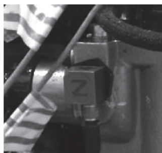
图 3 油泵加速度测点
