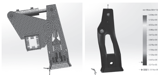
图7 钢轨牵引机械手有限元分析
