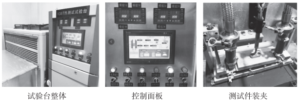
图 13 散热器台架测试
