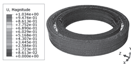
图 9 等截面四点接触球轴承整体有限元模型变形图
