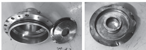
图2 密封腔体实物变形图
